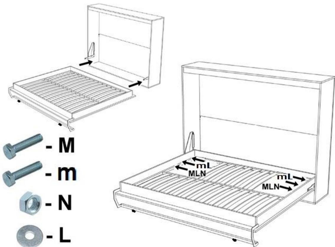
**\*\*\* Une fois les vérins installés il faut serrer à fond les équerres de fixation de la façade!**
