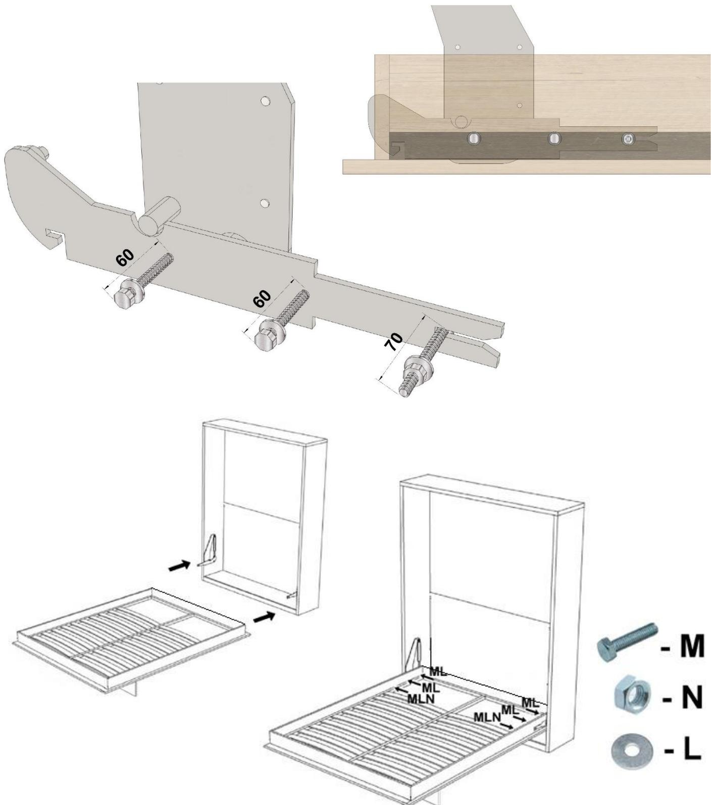
**\*\*\* Une fois les vérins installés il faut serrer à fond les équerres de fixation de la façade!**
