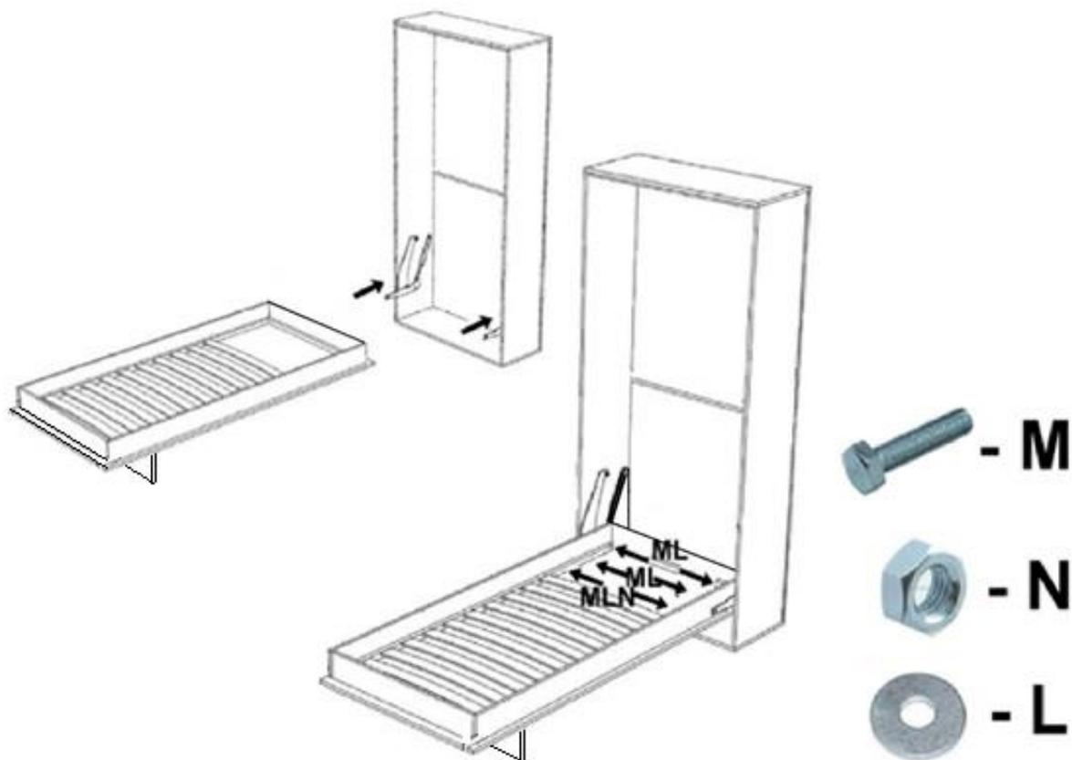
**\*\*\* Une fois les vérins installés il faut serrer à fond les équerres de fixation de la façade!**
