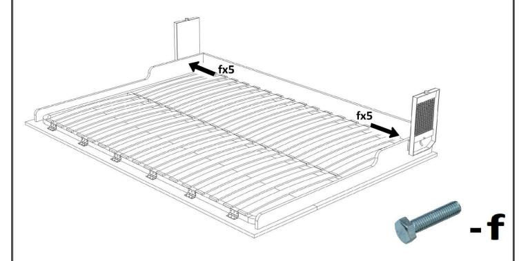
• Fixer le boîtier du mécanisme sur les montants de la structure
