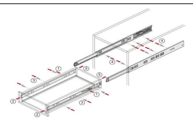
En poussant le levier de déconnexion (1), retirez le brin mobile de la glissière (2) et fixez-le avec des vis (3) sur les deux cotés du tiroir. Conformément au plan de perçage, vissez des glissières fixes (4) sur les cotés de l'élément. Faites glisser les brins mobiles du tiroir dans les glissières externes sur l'élément . Poussez doucement le tiroir (5) jusqu'à ce que le levier de déconnexion s'enclenche. Utilisez également le levier de déconnexion pour retirer le tiroir.
