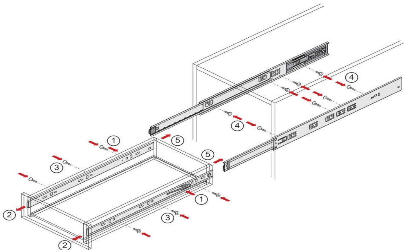
*En poussant le levier de déconnexion (1), retirez le brin mobile de la glissière (2) et fixez-le avec des vis (3) sur les deux cotés du tiroir. Conformément au plan de perçage, vissez des glissières fixes (4) sur les cotés de l'élément. Faites glisser les brins mobiles du tiroir dans les glissières externes sur l'élément . Poussez doucement le tiroir (5) jusqu'à ce que le levier de déconnexion s'enclenche. Utilisez également le levier de déconnexion pour retirer le tiroir.*
